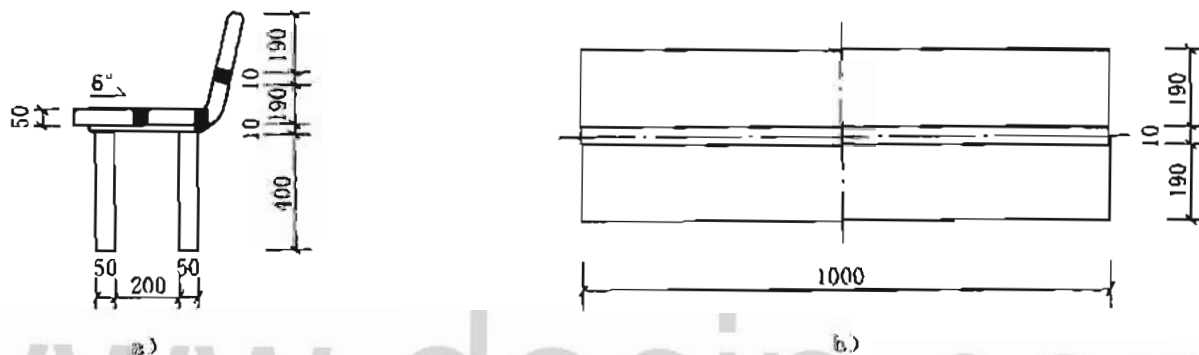
图 3-20 木制飞来椅构造示意图
